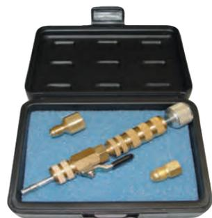
Ce kit est le seul extracteur de noyau de vanne incorporant un écrou de sécurité. Celui-ci permet au technicien d'engager le noyau de vanne sans avoir à lutter contre la pression. Il est livré avec un raccord flare 1/2"-20 UNF, un raccord flare 1/4" et une boîte de transport en plastique.
