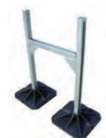
Composition du kit : 2 pieds, 2 patins antivibratiles avec rattrapage de pente, 2 inserts, 2 équerres, 4 vis et 4 écrous M10, 1 notice d'installation. Le kit ne comprend pas les rails en acier.
