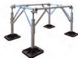
Le châssis, selon la réglementation DTU 43.1, permet de surélever les unités de 730 à 800 mm. Les pieds sont démontables individuellement permettant d'effectuer les opérations d'entretien de la toiture et les éventuelles réfections sans démontage de la structure.
