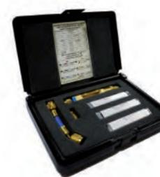
L'utilisation du détecteur de polluant CHECK-MATE sert à déterminer correctement le niveau d'acidité et d'humidité dans n'importe quel CFC, HCFC ou HFC. La mallette contient 3 tubes détecteurs (humidité, acidité et test d'huile), un corps de détecteur, un flexible d'extension, un connecteur MM 1/4" SAE et le tableau d'interprétation des résultats.
