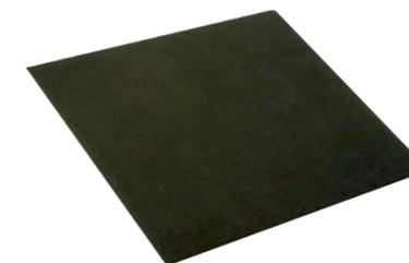
La plaque élastomère DALLISOL peut être utilisée pour une isolation active (amortissement des vibrations provenant des éléments mobiles supportés) ou pour une isolation passive (vibrations des structures du bâtiment).
