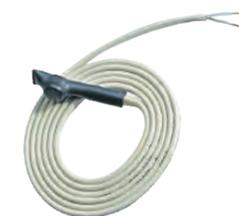
Conçu pour être immergé au fond des bacs à condensats, il permet d'éviter les prises en glace. Il est équipé d'un thermostat antigel qui se déclenche à +5 °C.
