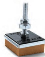
Ce support intègre dans sa partie supérieure une plaque de caoutchouc synthétique anti-dérapante. Le kit de mise à niveau repose sur la surface antivibratoire, isolant complètement l'unité de climatisation de son support.
