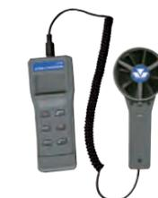
Mesure humidité, température de l'air, point de rosée, température du bulbe humide, vitesse de l'air, volume de l'air et BTU.
